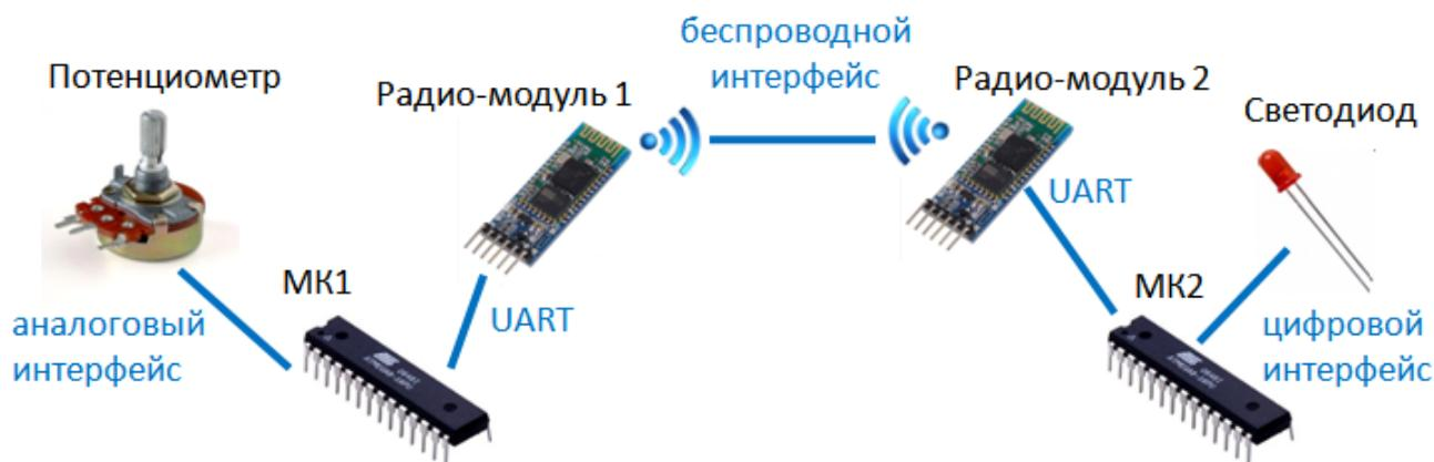
Рис. 2. – Пример микроконтроллерной схемы
